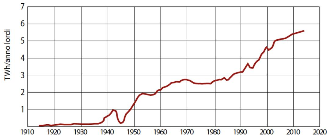
Figura 31. Andamento della produzione di energia elettrica da fonte geotermica in Italia.
