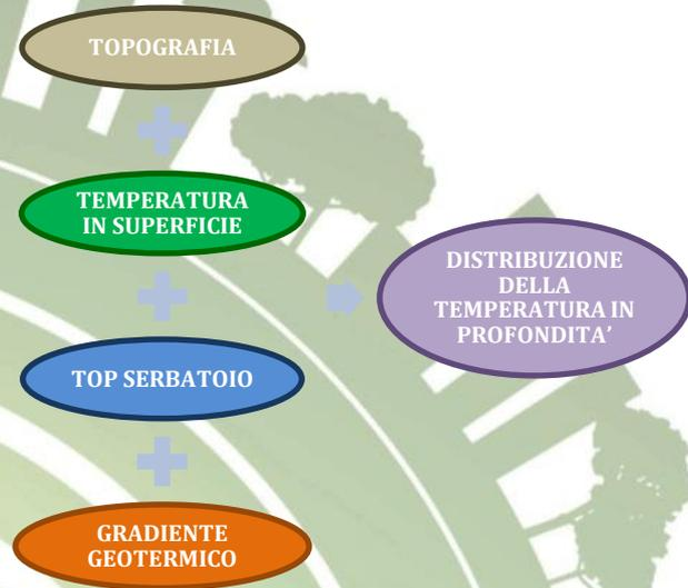
Il calcolo del potenziale utilizza in input il modello termico realizzato, dalla superficie topografica fino a 5km di profondità (s.l.m.)
